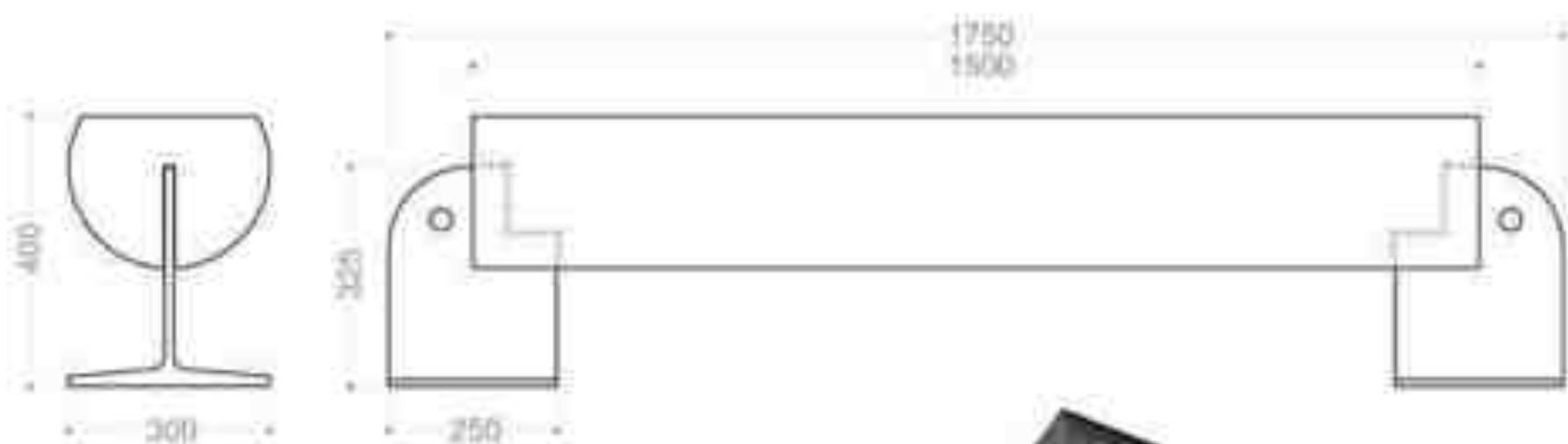
La base metallica è facilmente posizionabile grazie ai fori nella parte superiore che permette di ancorarla ad un argano.
